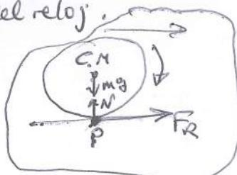
Es decir, el cilindro en conjunto (su C.M.) se mueve cada vez más rápido pero va frenando su rotación alrededor de su eje hasta que rueda sin deslizar y entonces  $V_{CM} = \omega \cdot R$
