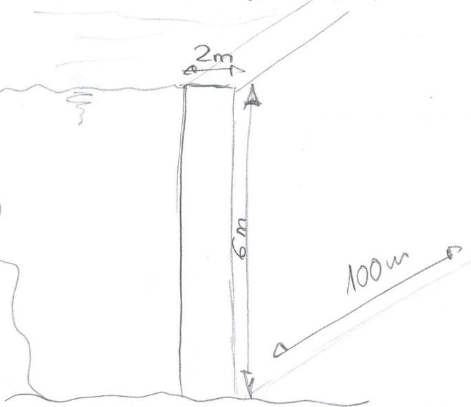
a) Tenemos un paralelepípedo en el cual va a aparecer una presión hidrostática debida al fluido contenido (agua). Por el principio de Pascal, esta presión se ejerce en todas direcciones ( $p$  es escalar).
